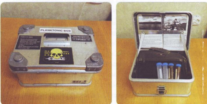
Рис. 5.5. Полевой кейс для хранения планктонных проб и аксессуаров
