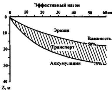
Рис. 2.1. ЭТА-диаграмма для мелкодисперсных (0–1 см) поверхностных осадков оз. Ванерн (Håkanson, 1976)
