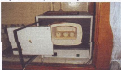
Рис. 3.2. Прокаливание проб в муфельной печи
