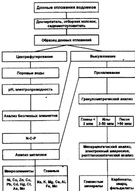
Рис. 2.8. Общая схема пробоподготовки и проведения анализа донных отложений
