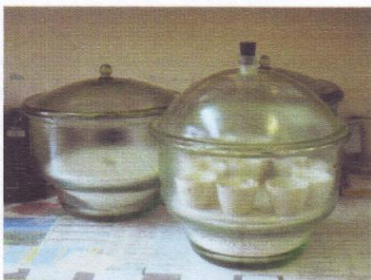
Рис. 3.1. Керамические тигли с просушенными пробами в эксикаторе
