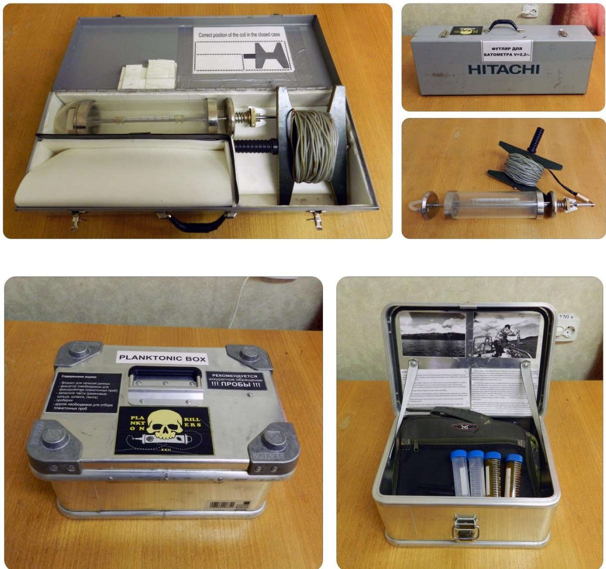
Рис. 5.4. Специализированный футляр для хранения и транспортировки батометра Рис. 5.5. Полевой кейс для хранения планктонных проб и аксессуаров
