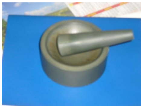
Рис. 3.3. Яшмовая ступка и пестик для растирания прокаленных проб
