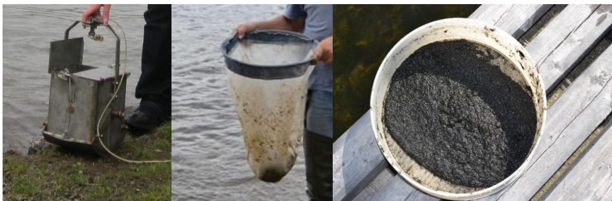
Рис. 6.1. Орудия для сбора организмов зообентоса: (слева направо) дночерпатель Экмана – Берджа, сачок для промывки грунта, грунт
