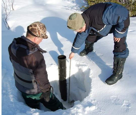
Рис. 1.3. Отбор проб снега
