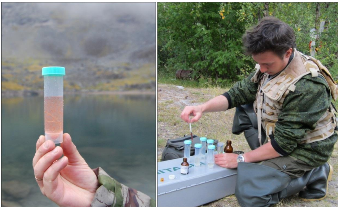
Рис. 5.6. Нефиксированная проба (слева) и фиксирование пробы в полевых условиях (справа)
