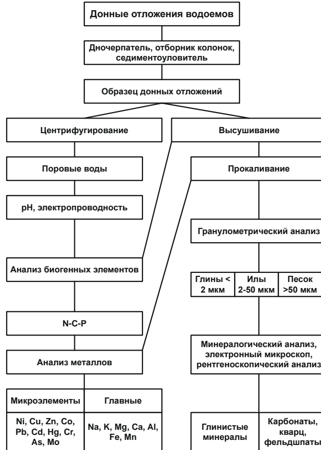
Рис. 2.8. Общая схема пробоподготовки и проведения анализа донных отложений (Förstner, Wittmann, 1979, с изм. и доп.)
